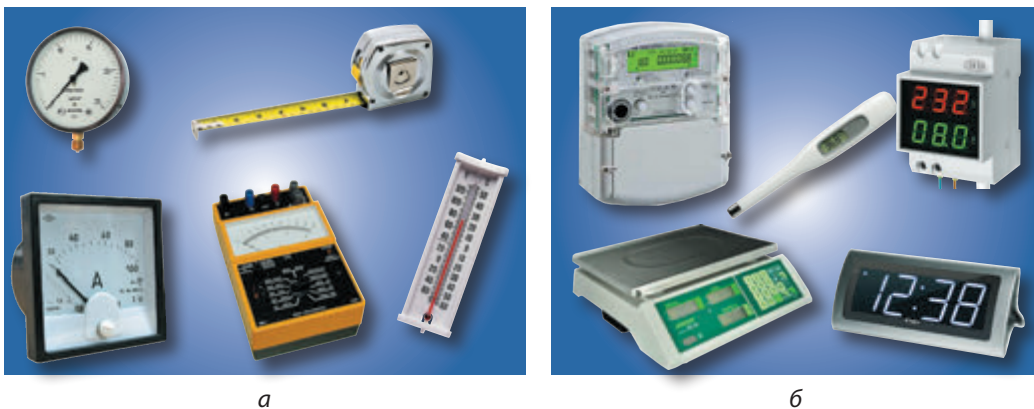
Рис. 4.6. Вимірювальні прилади: a — зі шкалою; б — електронні цифрові
