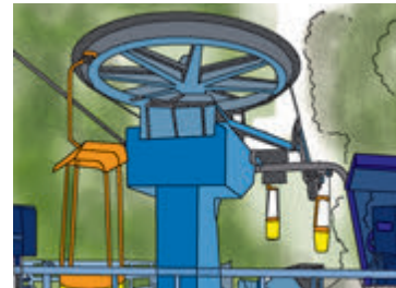
Рис. 35.3. Нерухомий блок у механізмі канатної дороги змінює напрямок дії сили натягу каната (а отже, напрямок руху каната) на протилежний
