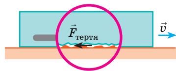
Рис. 21.7. Виникнення сили тертя пов'язане з наявністю нерівностей на поверхнях дотичних тіл
