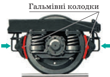
Рис. 33.4. Колесо потяга під час гальмування
