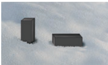
Рис. 22.1. Дерев'яний брусок провалюється в сніг більше, якщо він поставлений на меншу грань
